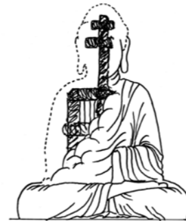
図 11 木心の設置と塑像の製作
